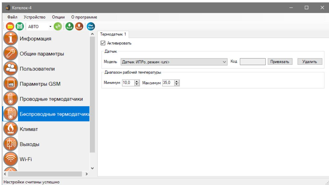
К прибору можно подключить 1 беспроводной датчик температуры. Диапазон измеряемых температур: -55°C до +125°C. Чтобы добавить датчик температуры, нужно установить флаг «Активировать». После этого станут доступны новые окна.
