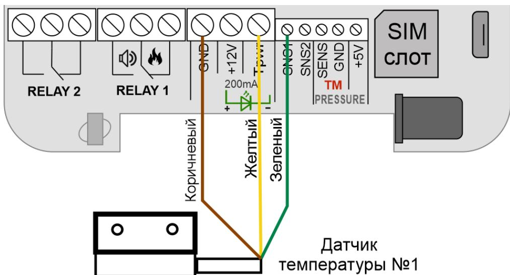
**ВНИМАНИЕ!** Если датчик температуры, который управляет котлом, выйдет из строя, то прибор перейдет в режим "Аварийной работы". Это значит, что после перехода в этот режим, котел будет включен на **15 минут**, затем он будет выключен на **45 минут**, цикл включения и отключения котла будет повторяться до тех пор, пока не будет восстановлен датчик температуры.
