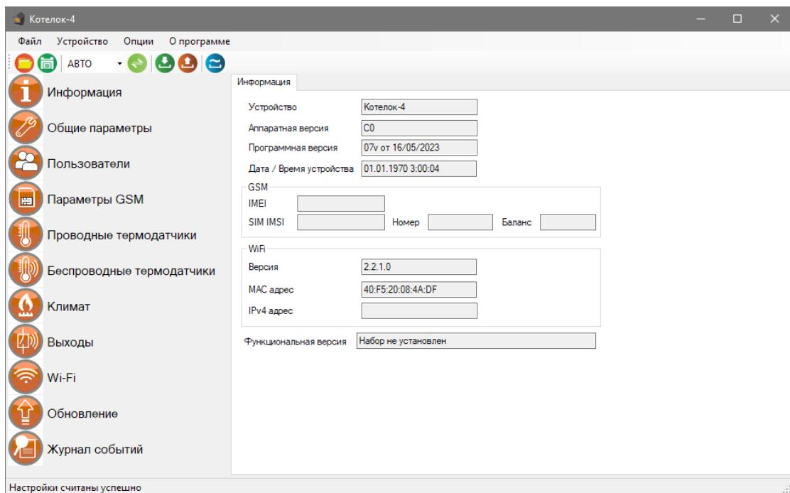
В данном экране можно посмотреть версию программного обеспечения и аппаратную версию прибора, IMEI прибора, номер и баланс sim-карты, MAC адрес Wi-fi модуля.
