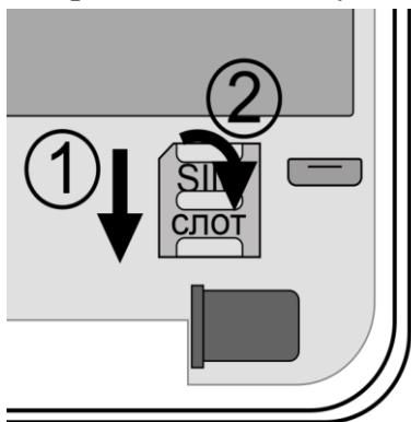
Установите sim-карту в слот и закройте его крышку, сдвинув её вверх:
