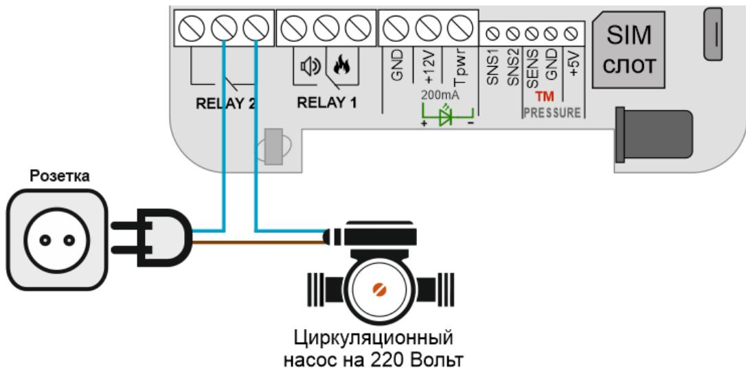
**Внимание!!!** При подключении большой индуктивной нагрузки, рекомендуется ставить искрогасящую цепь.
