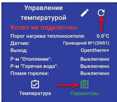
При нажатии кнопки «Обновить», на экране будут отображены текущие параметры. У каждого котла свой набор параметров, которые он передает по шине OpenTherm. Например, некоторые котлы не передают: давление в системе и уровень пламени.
