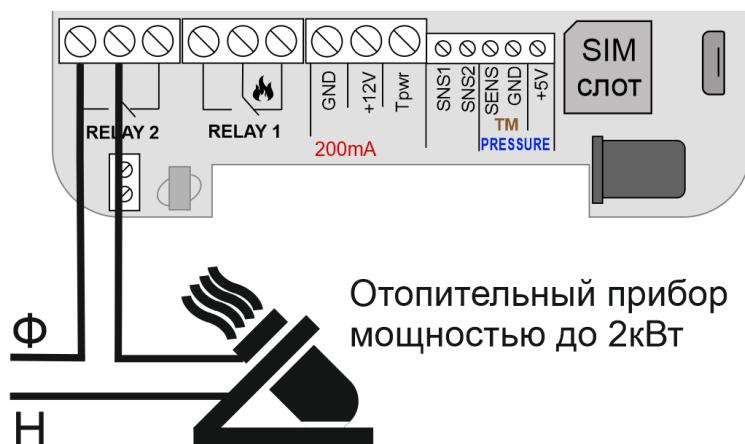
**ВНИМАНИЕ!!!** При подключении нагрузки, необходимо учитывать пусковой ток, подключенного оборудования.
